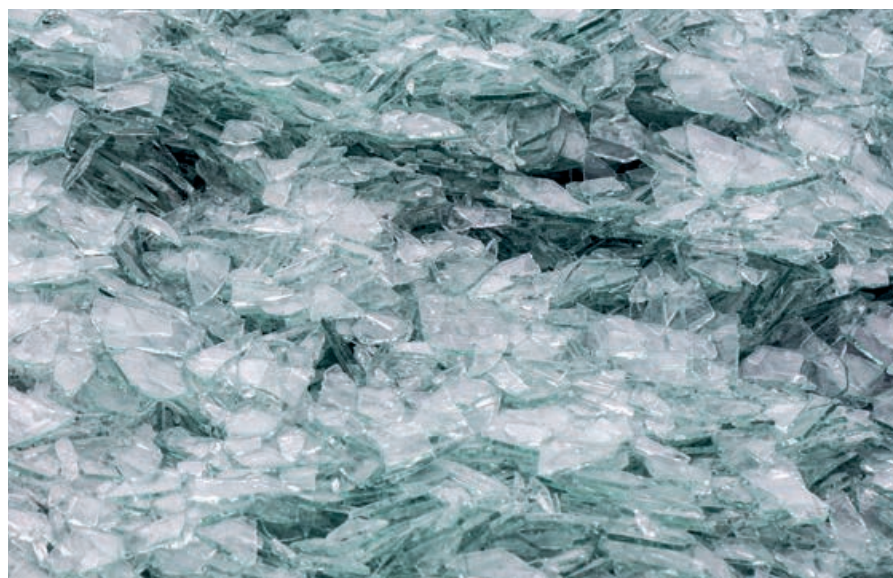
▲ Meer glasscherven terug de oven in zorgt ervoor dat er minder grondstof nodig is, maar betekent bovenal een lagere smelttemperatuur en dus minder energieverbruik.
